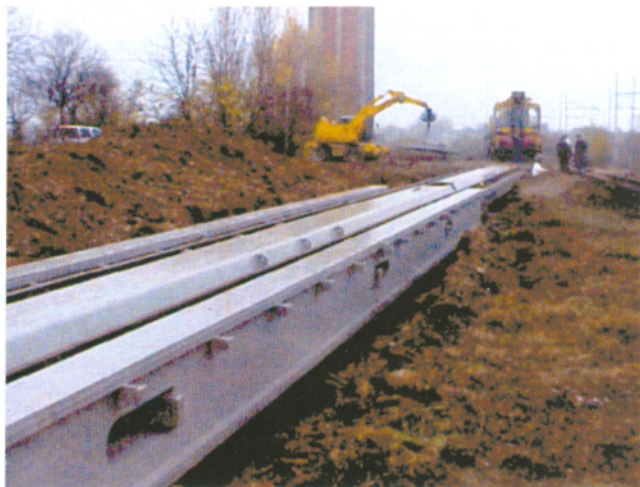
12. I due ponti Bologna assemblati «in serie» durante il collaudo statico.
