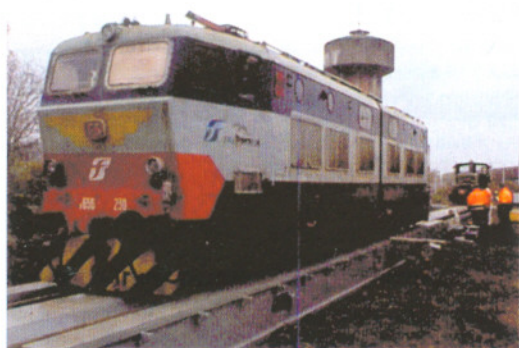
13. Le operazioni di collaudo «fuori opera» dei prototipi dei ponti Bologna mediante locomotore 656.
